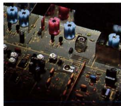
● Stadio anteriore GaAs che impiega tecnologia per satelliti per ottenere un elevato rapporto S/R
